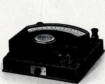
Bild 14. Tischinstrument mit Spitzenlagerung der Drehspule.
